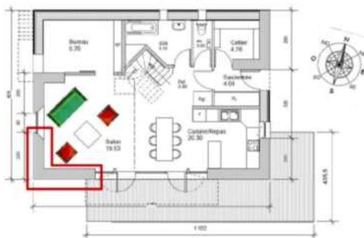
Figure 13. Présentation du mur instrumenté (encadré rouge)
