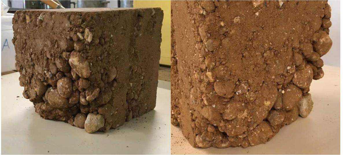
Figure 36 : Photos d'un cube tamisé à 50mm ayant un coin très abimé
