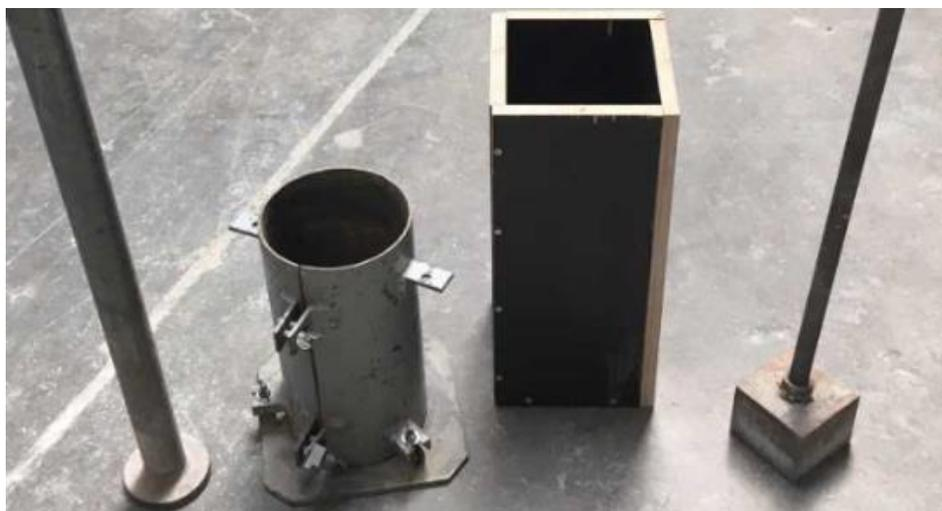
Figure 34 : Photo des éléments nécessaires à la fabrication des échantillons de chaque géométrie
