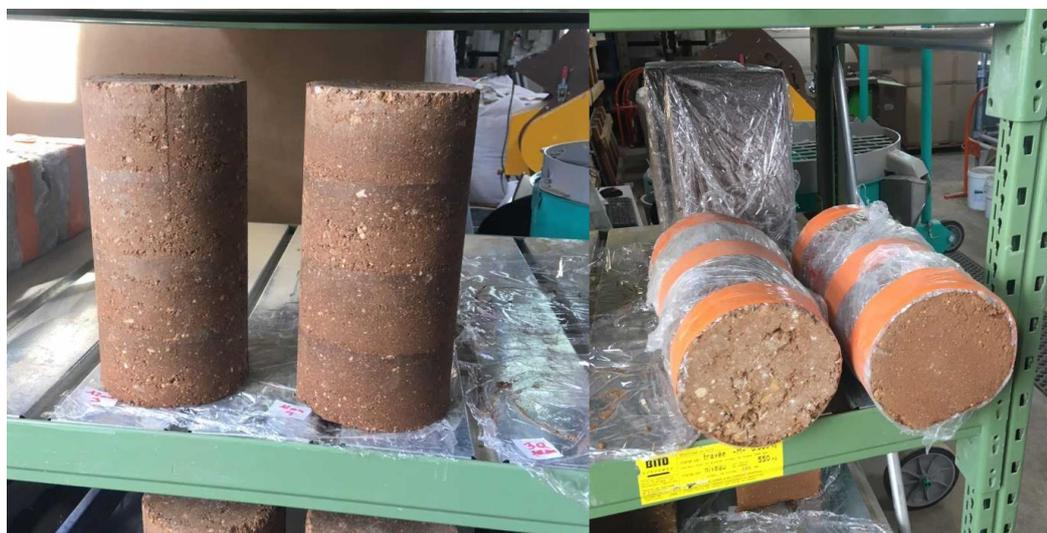
Figure 33 : Photos des échantillons cylindriques en train de sécher, à gauche en 3D et à droite en 1D
