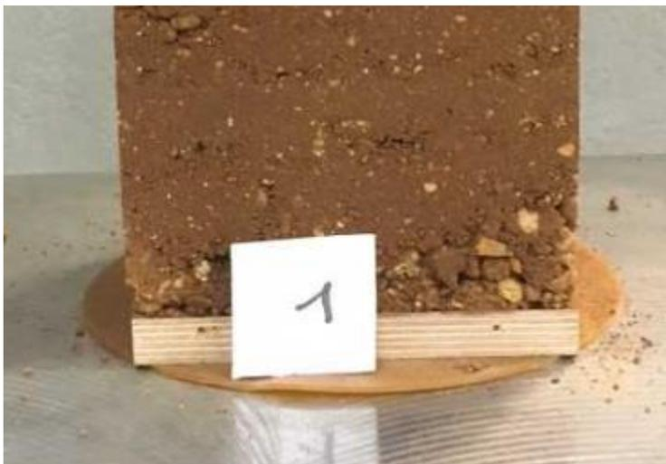
Figure 37 : Photo d'un échantillon prismatique au-dessus de la base du coffrage en bois
