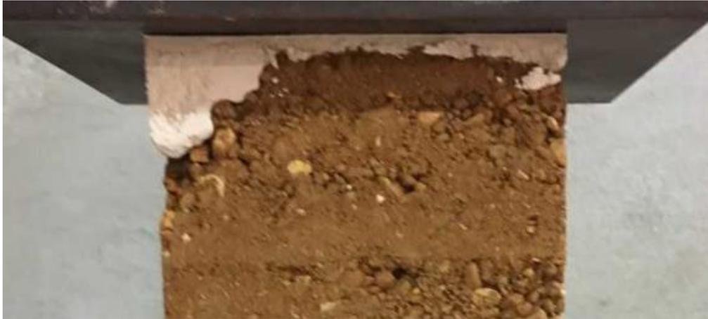
Figure 35 : Photo d'un coin de prisme très abimé
