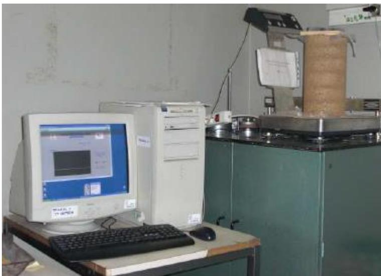
Figure 42 : Photo d'un dispositif d'acquisition de la masse (Photo MOLLION)
