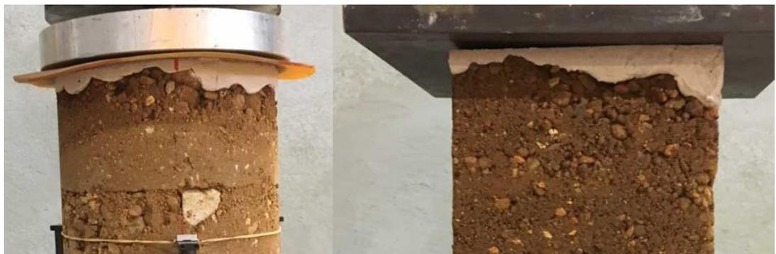
Figure 29 : Photo d'échantillons ayant eu besoin d'un surfaçage supérieur car ils étaient abimés
