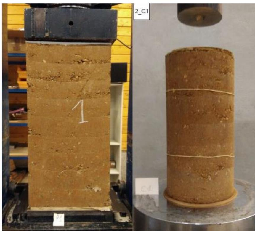
Figure 24 : Photo d'un échantillon prismatique à gauche, et d'un échantillon cylindrique à droite
