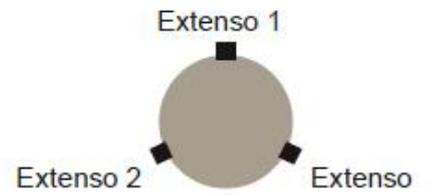
Figure 30 : Photo et schéma de la disposition des extensomètres sur les échantillons cylindriques
