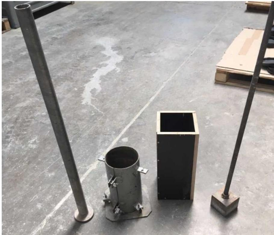
Figure 27 : Photo des coffrages et dames utilisés pour la fabrication des échantillons
