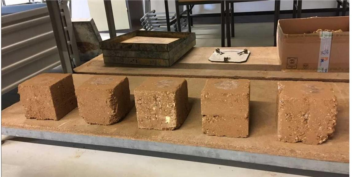
Figure 20 : Photo de 5 de 6 cubes destinés aux essais de rétention d'eau
