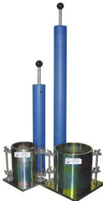
Figure 8 : Matériels de l'essai Proctor normal à gauche et modifié à droite (Image Google)
