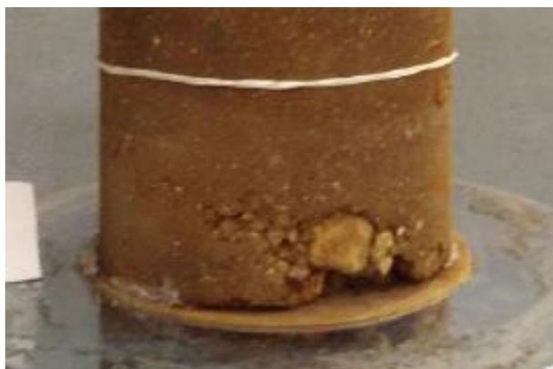
Figure 40 : Photo d'un échantillon cylindrique dont la base est abîmée par un gros granulat
